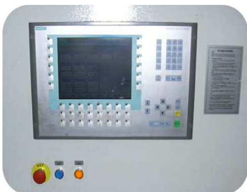
Die aktuellen Maschinenzustände werden mittels Siemens Display OP270 visualisiert.
